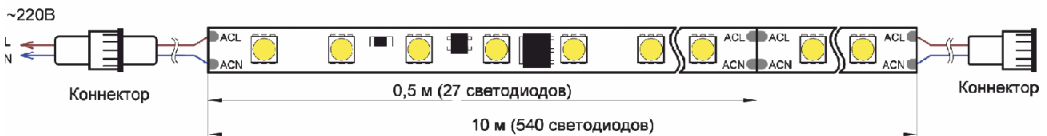
Светодиодная лента ARL-W5060PG-54-220V 10 м (максимальное подключение 50 м - 5 катушек)
